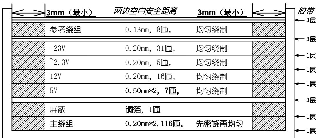
图 5、例 2, T1,EEL19,1mH 变压器结构
